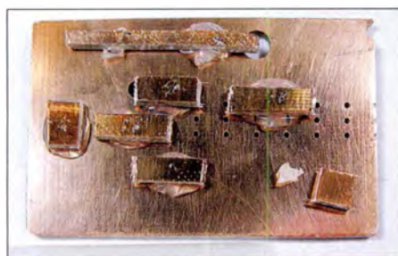
Aufgeklebte Lötstützpunkte, hier noch mit Heißkleber fixiert; das lange Stück oben dient als Spannungsschiene.
