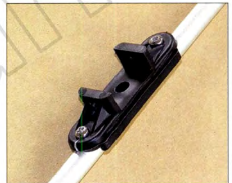
Bild 12: Befestigung des Open-sleeve-Elements auf dem Polyamid-Halter
