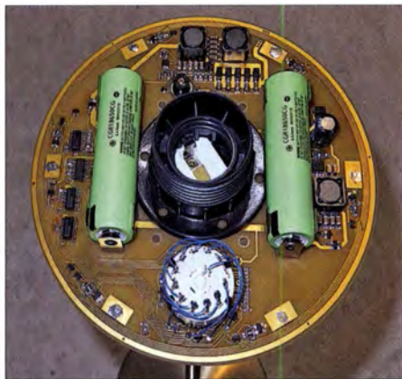
Bild 4: Blick auf die Platine; die LEDs befinden sich auf der Unterseite. Die verzwickte Verdrahtung des Stufendreh Schalters wurde später im Layout korrigiert. Fotos: DL1SNG
