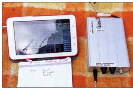
Als Display für seinen in einem Euro-Gehäuse untergebrachten PSK31-Transceiver nutzt Helmut Seifert, DL2AVH, ein Samsung Galaxy Tab3 Lite samt passender Software. Foto: DL2AVH
