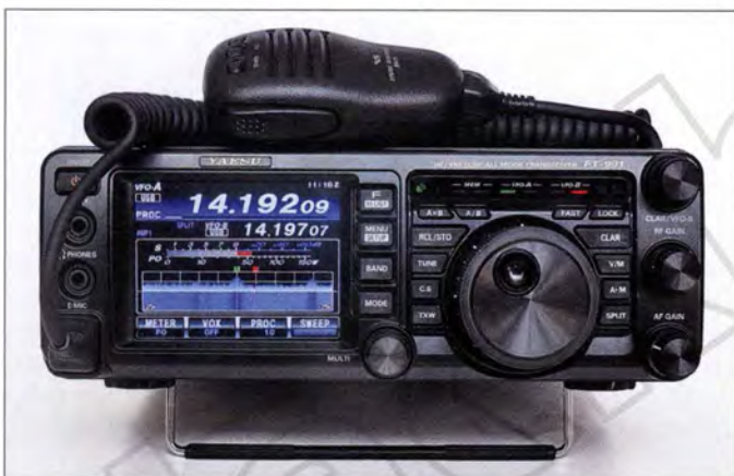
Bild 1: Der FT-991 hat ein modernes Design und ist etwas breiter als sein Vorgänger. Insbesondere profitiert er von seinem berührungsempfindlichen TFT-Farbbildschirm.
