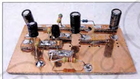
Die Bauteile werden auf den Lötstützpunkten oder der Massefläche aufgelötet.
