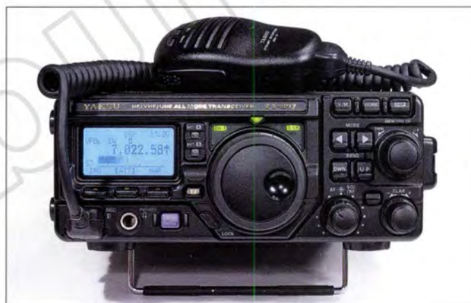
Bild 2: Der Vorgänger FT-897, hier maßstabsgerecht dargestellt, ließ sich auch aus einem Akkumulator mit 4500 mAh betreiben, der im unteren Teil des Inneren Platz fand.
