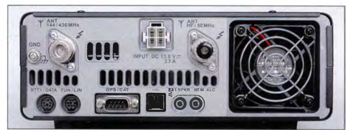
Bild 4: Die Rückfront des FT-991 wirkt recht aufgeräumt; die Stromversorgung erfolgt über die inzwischen zum Standard gewordenen vierpoligen Buchsen.
