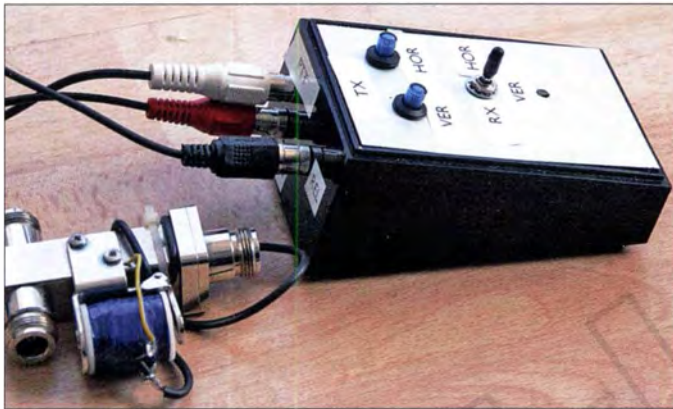
Bild 1: Ausführungsbeispiel einer Umschalt-einheit; links daneben ist das verwendete Koaxial-relais CX600 zu sehen.
