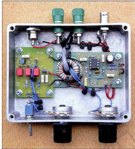
Bild 11: Schleifenabstimmmodul mit Entdämpfung und geschirmter Primärwicklung zur Unterdrückung des Antenneneffekts
