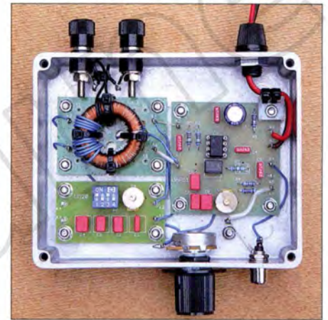
Bild 9: Versuchsmodul für den entdämpften Betrieb mit Pufferverstärker V = 1
