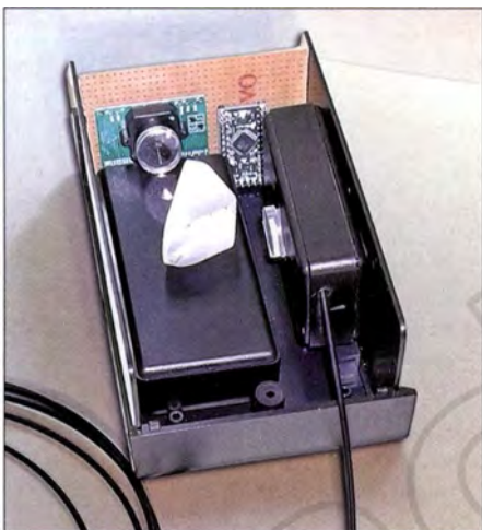
Bild 1: Der Aufbau muss in einem schwarzen Gehäuse erfolgen. Bei dem Versuchsaufbau wurde anstelle des Lichtspalts das in der Astronomie übliche Verfahren mit einer Glasfaser verwendet. Foto: Sander
