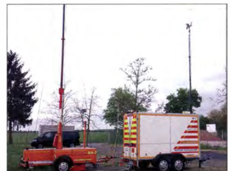
Mobile Kurzwellenstation MF2-MA2
