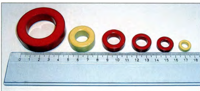
Bild 13: Größenvergleich einiger Ringkerne, von links nach rechts T-200, T-106, T-94, T-80, T-68, T-50
