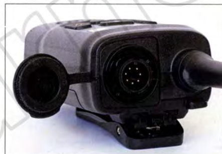
Oben auf dem Handfunkgerät sind eine fest angebrachte Antenne und die Mikrofonbuchse angeordnet. Fotos: DL1ABJ
