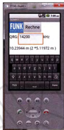
Bild 7: Um die Resonanz- frequenz von 14,0 MHz auf 14,2 MHz zu verschieben, müssen an beiden Dipolenden 7 cm ab- geschnitten werden.
