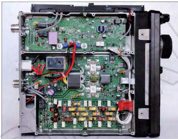
Bild 5: Am Boden gab es noch ein Abschirmblech zu entfernen; unten im Bild der automatische Antennentuner.
